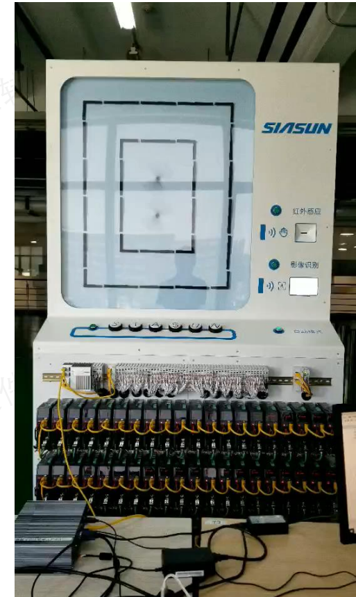
新松60轴+360点IO控制测试平台（测试多轴同步及稳定性）
