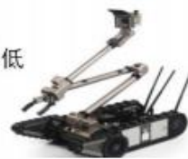
履带式机器人 松软、沼泽路面适应性强
